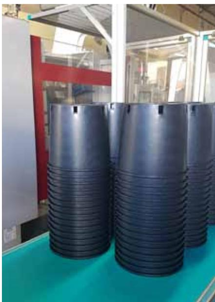
Bei der Firma *Centroplast SRL* in Montecarlo bei Lucca werden Pflanztöpfe aus Recycling-Kunststoff hergestellt, deren Produktionskonstanz und Oberflächengüte durch die Umstellung der Plastifiziereinheit auf *Maxi Melt*-Schnecken deutlich gesteigert werden konnten. Fotos und Grafiken: *Maxi Melt*
