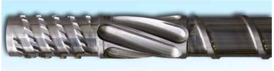
Mischverhalten einer Schnecke ohne Mischteil (oben) im Vergleich zur *Maxi Melt*-Mischerkombination an einer „Pack“-Schnecke für den Behälter-Spritzguss.
