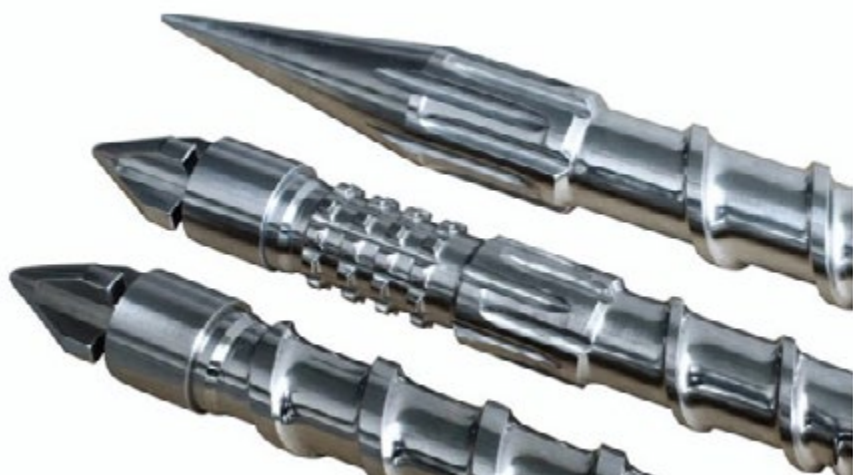
Bild 3: Durch ihre 1-Zonen-Auslegung schmelzen die Plastifizierschnecken von Maxi Melt materialschonend und homogen auf. MAXI MELT
